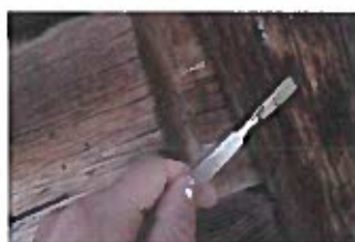
Foto nr.117 Prelevare probe binale
